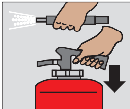
Löschschauch am Handgriff fassen, Brause auf Brandherd richten und Druckhebel niederdrücken.
